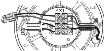
Připojte vodiče podle schématu zapojení.
