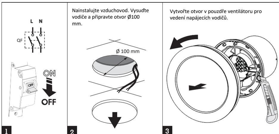
Připojte napájecí zdroj a nainstalujte jej do podhledu. Směřujte vodiče otvorem v pouzdře a nainstalujte ventilátor do vzduchového potrubí.
