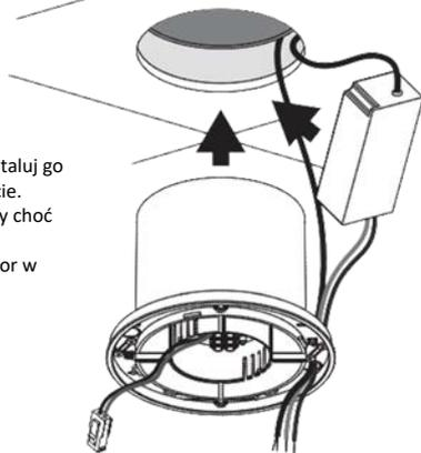
Zamocuj wentylator na powierzchni sufitu za pomocą śrub.
