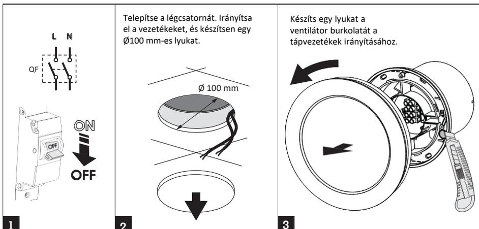
Csatlakoztassa a tápegységet, és szerelje be egy álmennyezetbe. Irányítsa át a vezetékeket a burkolaton lévő lyukon, és szerelje fel a ventilátort a légszatornába.
