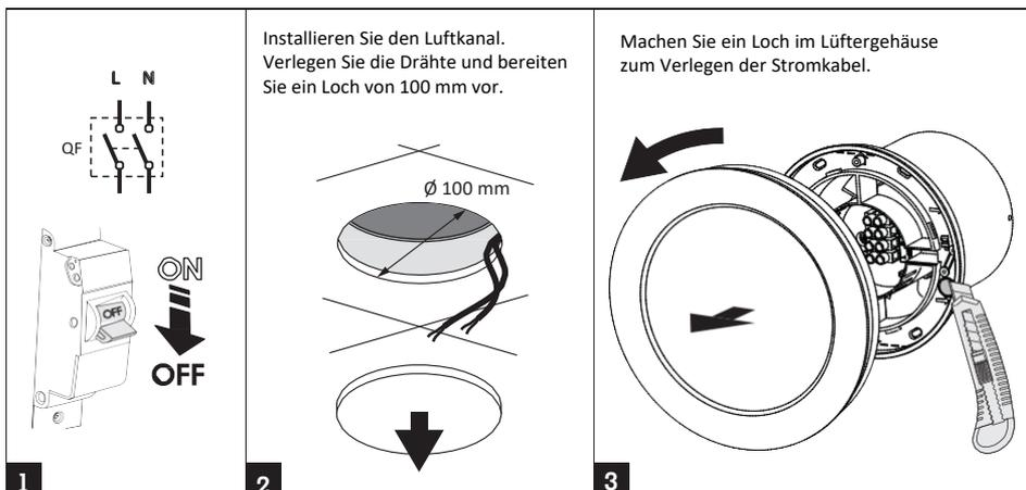
Schließen Sie das Netzteil an und installieren Sie es in einer Zwischendecke und installieren Sie den Lüfter im Luftkanal.
