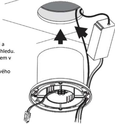
Upevněte ventilátor na povrch stropu pomocí šroubů.
