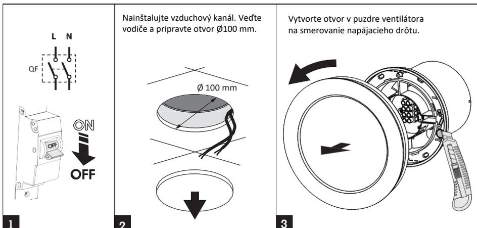
Nainštalujte vzduchový kanál. Vedte vodiče a pripravte otvor  $\varnothing 100$  mm.
