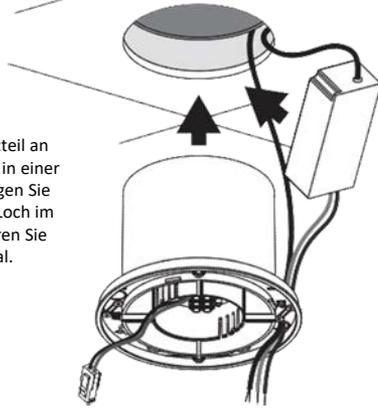
Befestigen Sie den Lüfter an der Deckenoberfläche mit den Schrauben.
