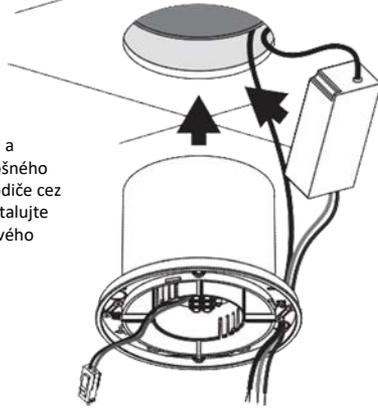
Upevnite ventilátor na povrchu stropu pomocou skrutiek.
